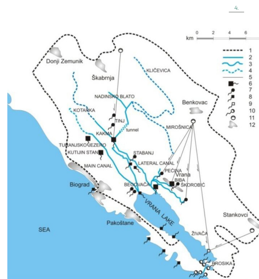
Slika 4. Sliv Vranskog jezera (Rubinić et al., 2010b). 1) hidrogeološka granica sliva; 2) regulacijski kanal; 3) stalni prirodni vodotok; 4) povremeni prirodni vodotok; 5) podzemna hidrogeološka veza; 6) izvor kaptiran za vodoopskrbu; 7) nekaptirani važniji izvor; 8) bočati izvor; 9) vrulja; 10) estavela; 11) ponor; 12) naselje.
