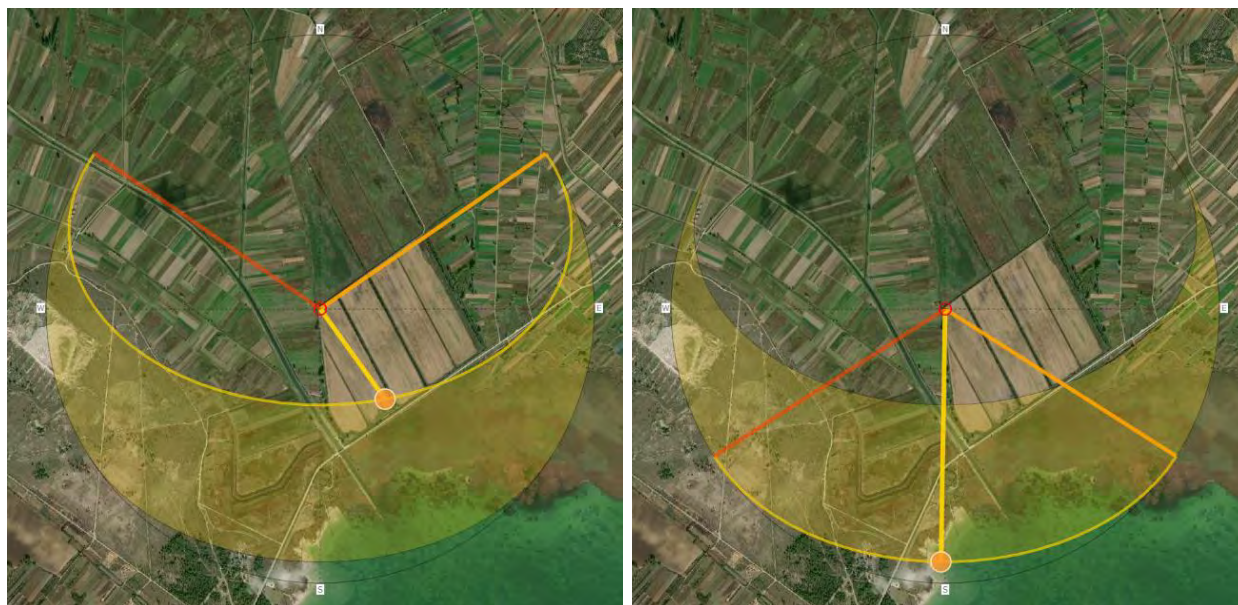
Slika 10. Prikaz dnevnih putanja sunca na području Jasen za vrijeme ljetnog suncostaja 21.6. (lijevo) i zimskog suncostaja 21.12. (desno) u vrijeme ravnodnevnice (12:00 h). Svijetlo narančasta linija predstavlja izlazak sunca, dok tamno narančasta linija predstavlja vrijeme zalaska sunca.
